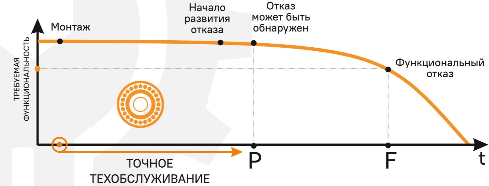
Форма кривой P-F интервала зависит не только от типа оборудования, но также и от методов точного технического обслуживания (входной контроль качества, качество запасных частей, следование инструкции по монтажу и ТО, строгие требования по допускам, центровка) и профилактических мероприятий.
