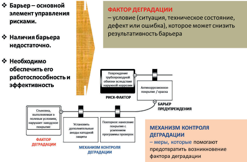
Рис. 4.1. Визуализация ФАКТОРОВ ДЕГРАДАЦИИ и МЕХАНИЗМОВ КОНТРОЛЯ ДЕГРАДАЦИИ на ДГБ
